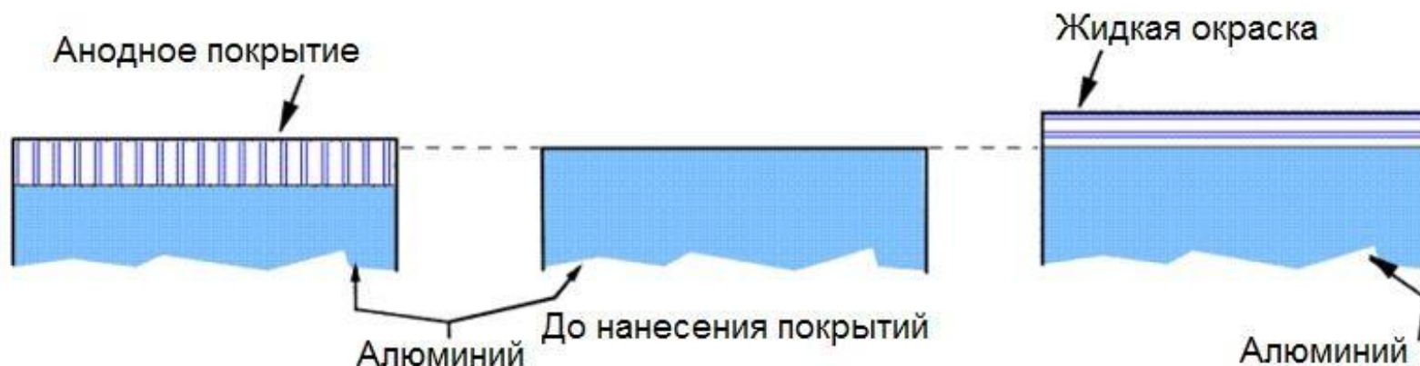
Рисунок 1 – Размерные различия между анодным покрытием и слоем краски
